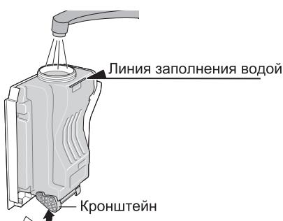
Бак можно установить на автоматически поворачиваемом кронштейне.
