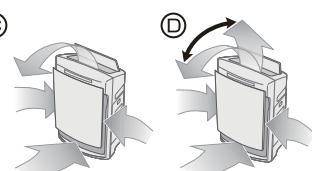
● Если для объема воздуха задана настройка «Выс», устройство работает с открытой передней панелью.
